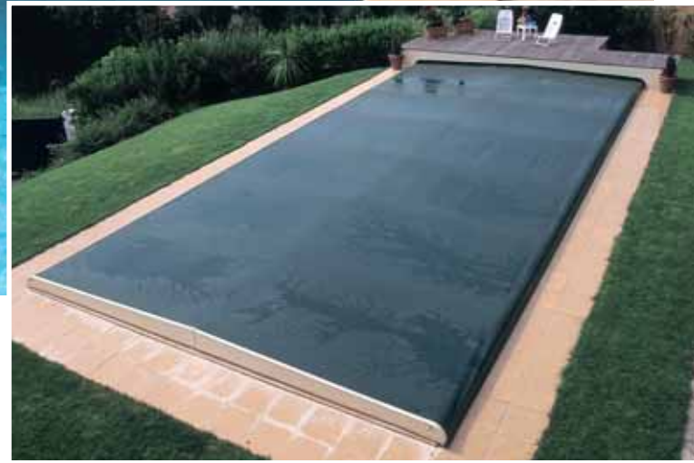
Pour des raisons de confort et de sécurité, la piscine est équipée d'une couverture automatique "toutes saisons" qui ferme intégralement le bassin sans être en contact avec l'eau car elle repose sur les margelles. Elle est stockée en bout de bassin dans le "coffre" recouvert de lames de bois, sur lequel on peut installer, table, chaises, jardinières fleuries. Au loin, les contreforts boisés des Pyrénées, nimbés de brume ferment l'horizon.
